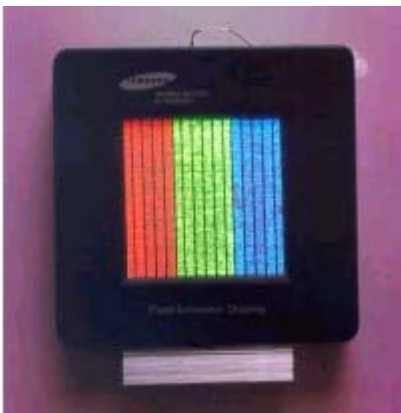
Slika 7. 4.5 - palčani zaslon u boji temeljen na tehnologiji s nanocjevčicama ugljika i razvijen u Samsungovom Advanced Institute of technology.
