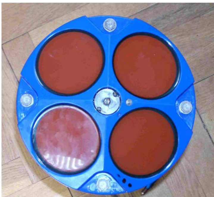
Slika 3.6 ADCP i leće (transducери)
