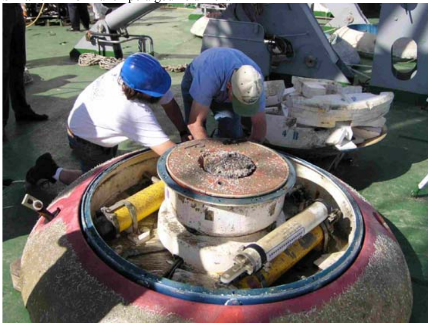
Slika 4.8 Razlika zaštićene i nezaštićene podloge od obraštaja
