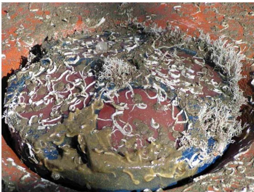
Slika 4.7 ADCP nakon pola godine u moru
