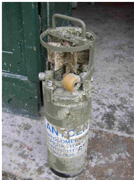
Slika 4.5 Aandera strujomjer nakon pola godine u moru
