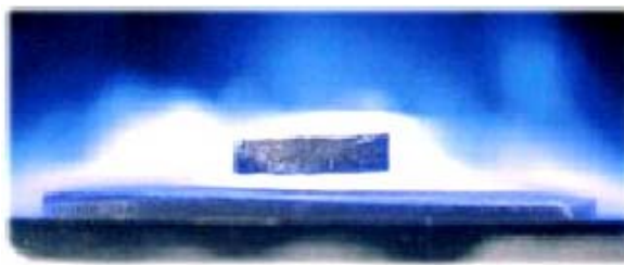
Slika 1 Supravodič ( YBa_2Cu_3O_7 ) lebdi iznad pola magneta jer je njegov magnetski moment M usmjeren suprotno od magnetskog polja H magneta.
