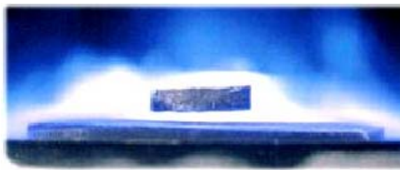
Slika 1 Supravodič ( \text{YBa}_2\text{Cu}_3\text{O}_7 ) lebdi iznad pola magneta jer je njegov magnetski moment M usmjeren suprotno od magnetskog polja H magneta.
