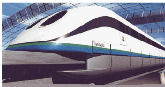
Slika 2 Vlak lebdi na magnetskom polju centralne tračnice po principu slike 1 i kreće se bez kotača brzinom od oko 500 km/h.
