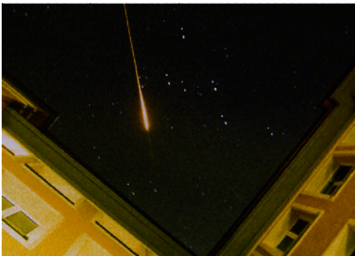
Slika 4-5: Fotografija samoinduciranog svjetlosnog filameta u zraku nastalog infra-crvenim (800 nm) fs pulsom velike snage [5].
