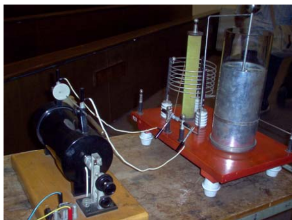
Slika 5. Lijevo: Školski Teslin VF-generator (Zavod za primijenjenu fiziku FER-a); Desno: visokonaponsko elektromagnetsko polje na vrhu sekundarne zavojnice izaziva svjetljenje fluorescentne cijevi u ruci studentice.
