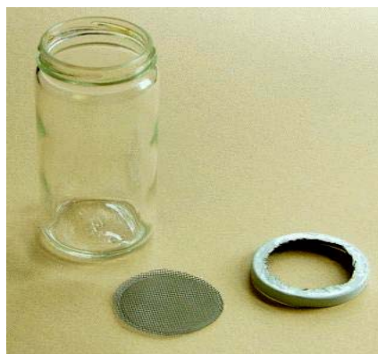
Slika 1.: Staklenka s poklopcem u kojem je izrezan otvor i mrežice različite veličine oka.
