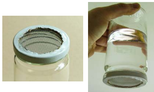
Slika 2.: Iz staklenke koja je poklopljena žičanom mrežicom, ne istječe voda.
