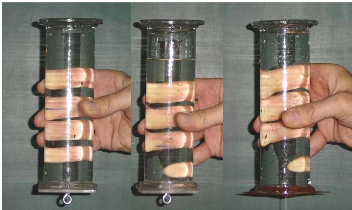
Slika 3.: Inačice pokusa s okrenutom čašom. Lijevo: cilindar posve napunjen vodom poklopljen pločicom od pleksiglasa; u sredini: djelomično napunjen cilindar; desno: cilindar poklopljen mrežicom.
