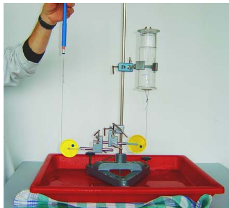
Slika 8.: Eksperimentalna izvedba za mjerenje sile na pločicu prislonjenu uz menzuru.
