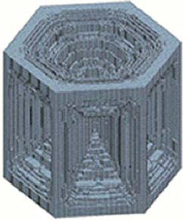
Slika 17: Prizma s konkavnim ploham; pojednostavljena simulacija; rast kontroliran difuzijom [10]
