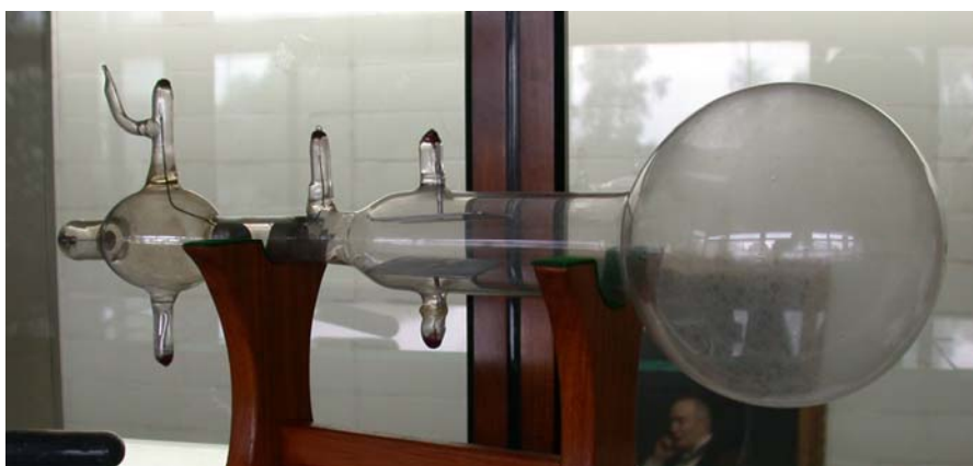
Slika 1. Dio eksperimentalne aparature pomoću koje je Thomson otkrio elektron.
