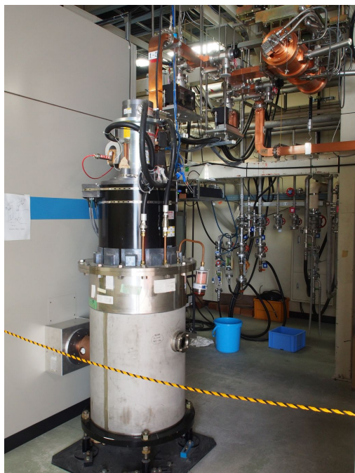
Slika 9.1: Primjer klistrona u jednom linearnom akceleratoru (KEK, Tsukuba, Japan)
