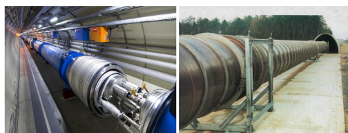
Slika 7.2: LHC (lijevo) među ostalim čini 9000 m 3 vakuumiranih cijevi, no LIGO detektor (desno) je čak i veći sa 10,000 m 3 vakuumiranog prostora.
