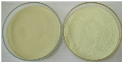
Slika 12.2: Fosforescentni pigmenti; lijevo: cinkov sulfid ( \text{ZnS} ); desno: stroncijev aluminat ( \text{SrAl}_2\text{O}_4 ).
